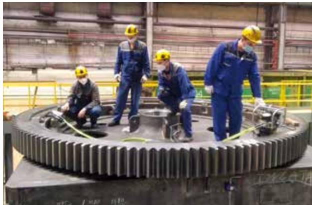
Бригада Милисовых на сборке зубчатого венца нижней рамы ЭКГ-12К
