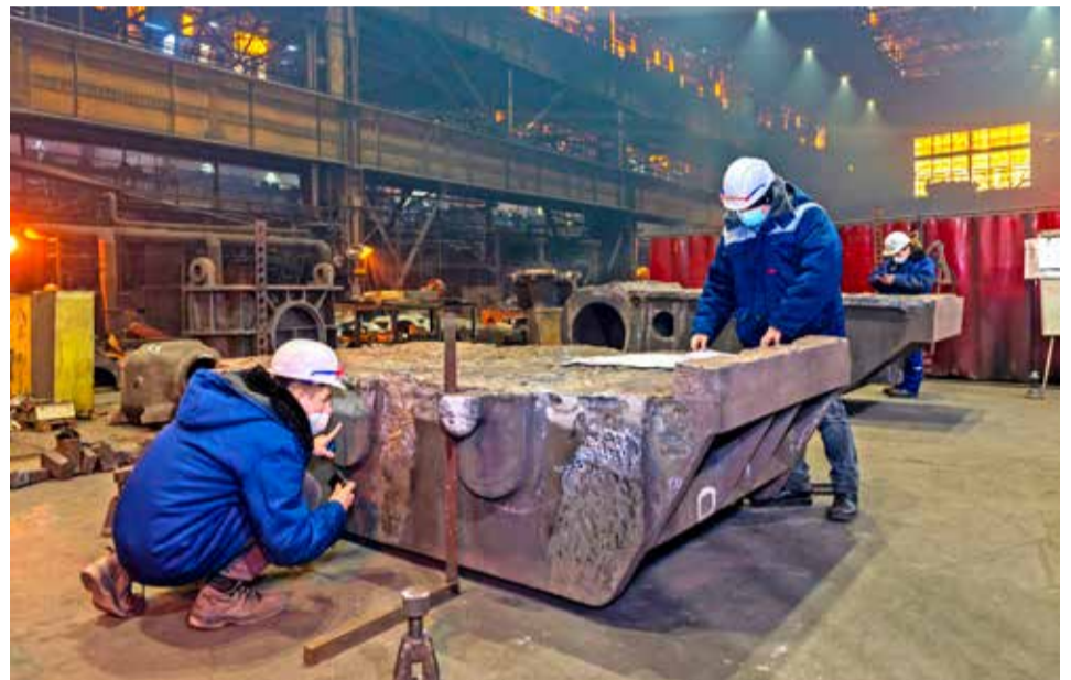
Специалисты УЗТМ оценили качество изготовления отливок для щековой дробилки со сложным качанием щеки
