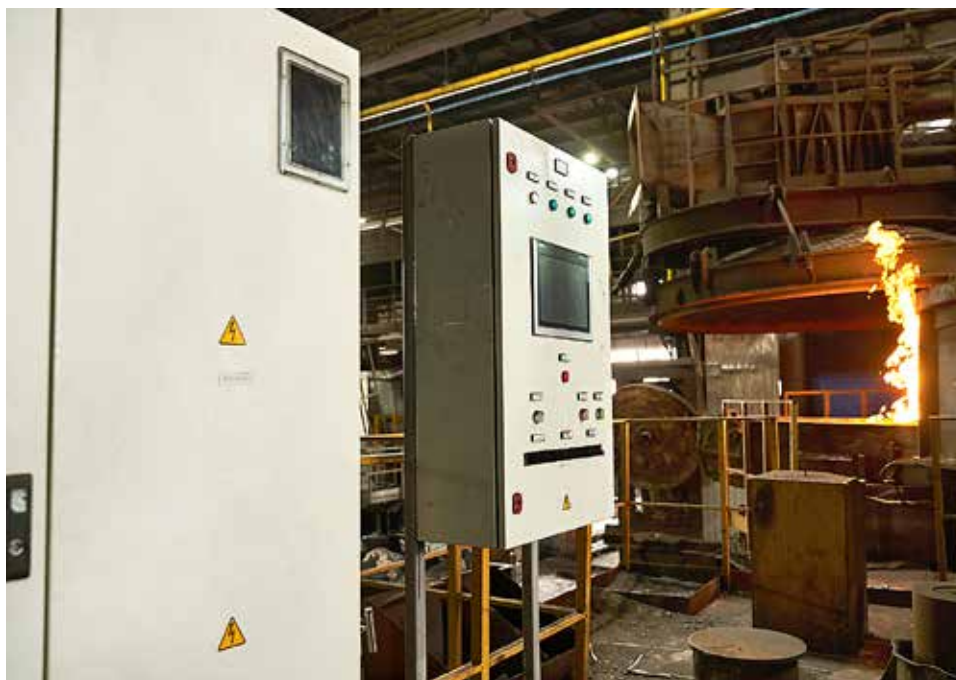
На пульте управления можно регулировать параметры продувки стали аргоном
