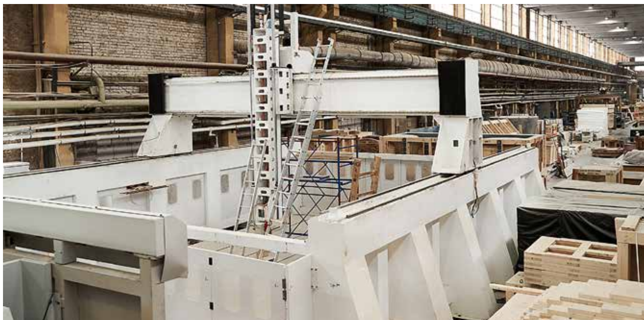
На новом портальном станке благодаря его размерам можно будет обрабатывать без переустановки самые крупные заготовки
