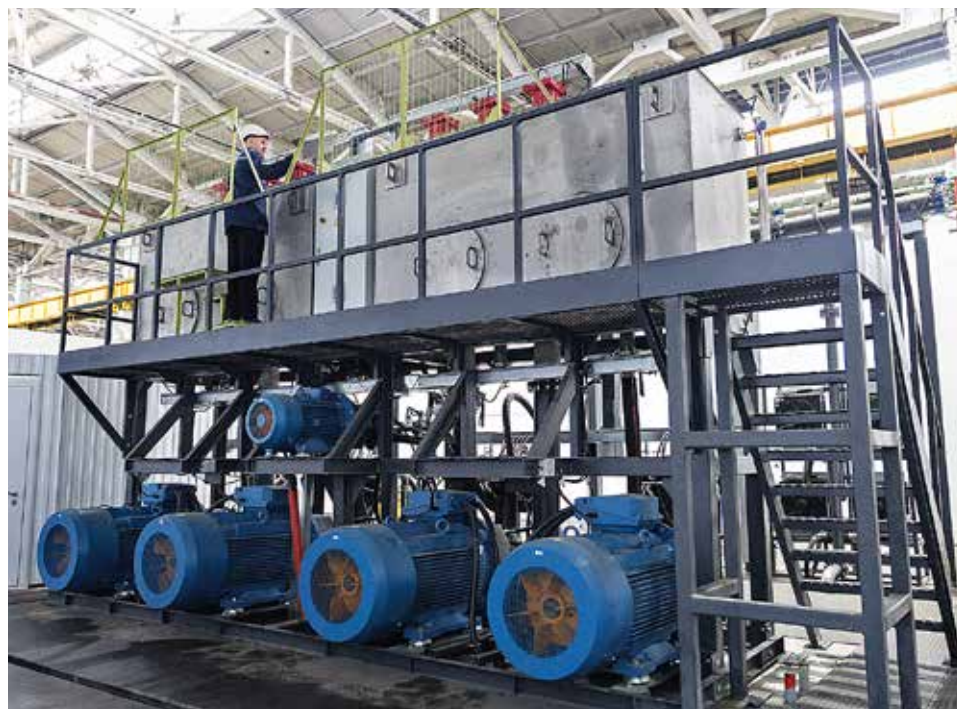
В центре нового испытательного стенда — два бака вместимостью 4 куб. м гидравлической жидкости каждый
