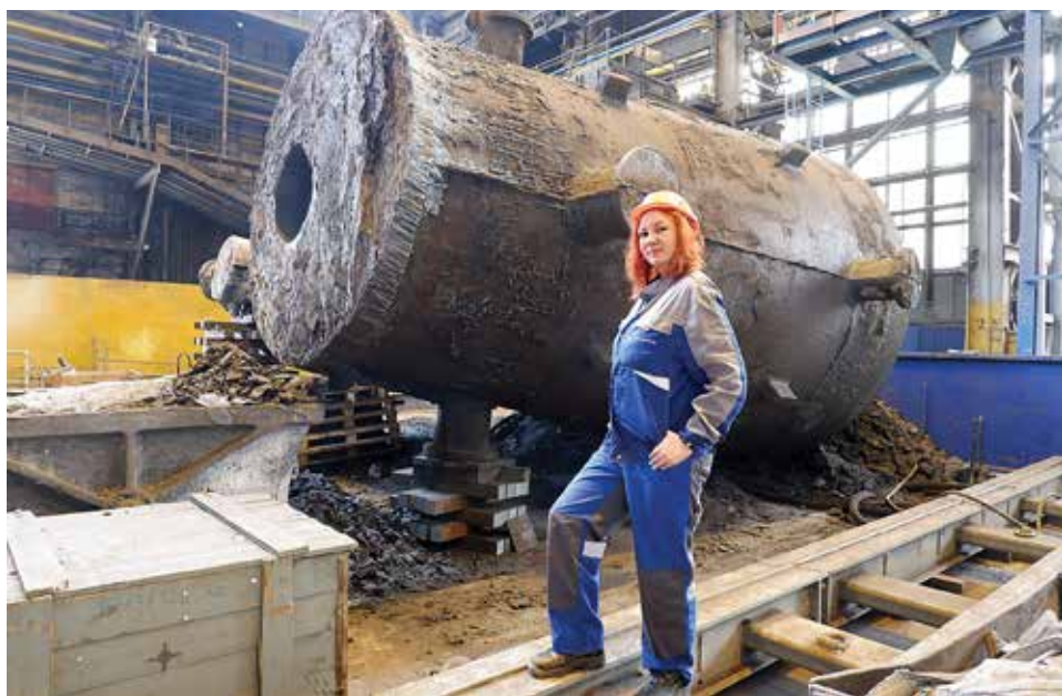
Наталья Тепликова участвовала в заливке самого большого в истории ЛП изделия — внешнего кронштейна гребного вала для ледокола «Лидер»
