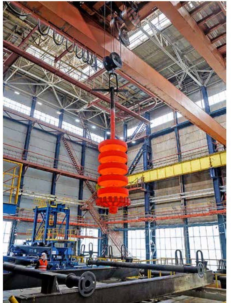
Закалка колес экскаватора с помощью модернизированного крана
