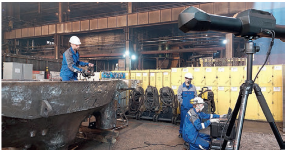
На сканирование одной заготовки может уходить от 30 минут до 20 часов – все зависит от формы и габаритов отливки
