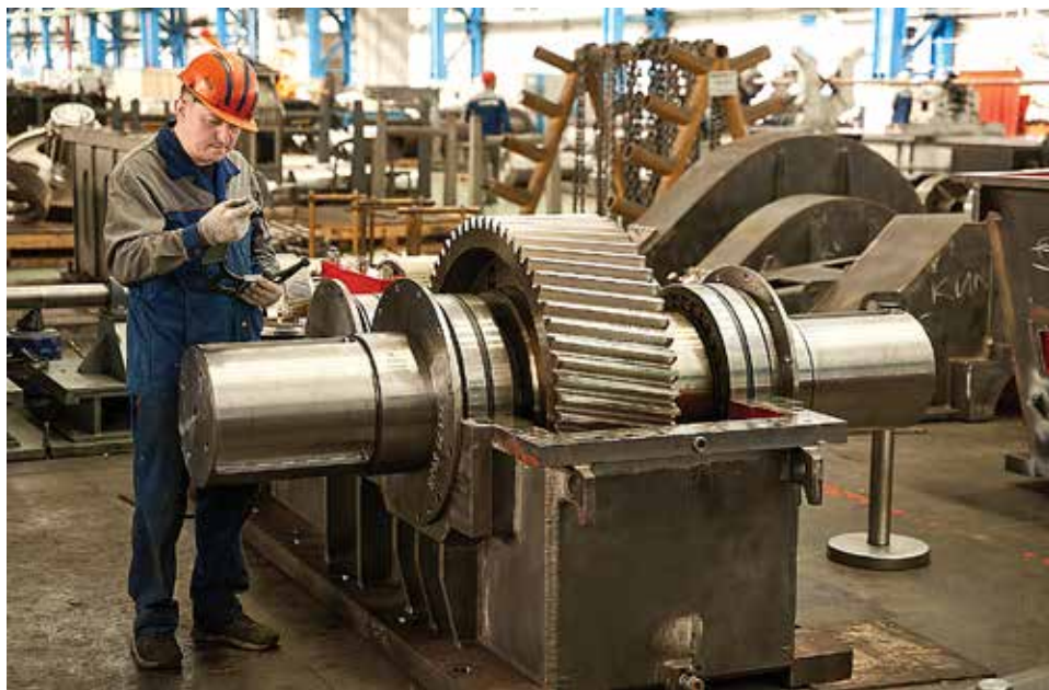
Редукторы кранов АЭС проходят самый жесткий контроль качества
