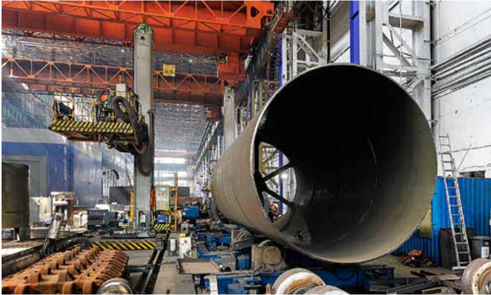
В блоке 10 УЗТМ идет сборка узлов первой прокалочной печи
